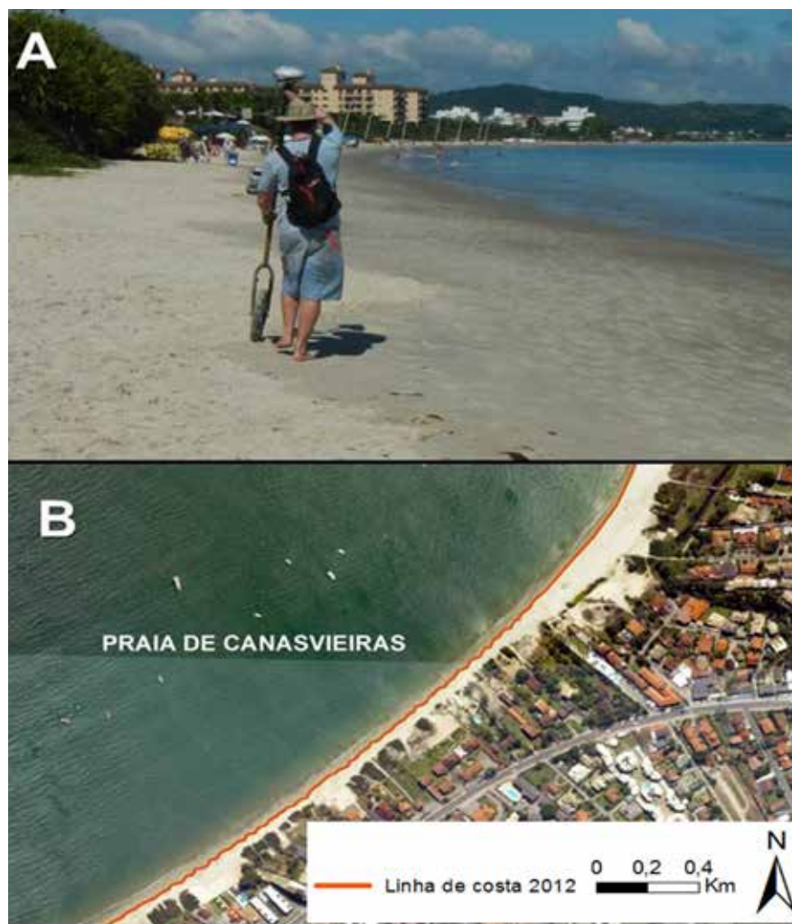
Figura 9: (A) Levantamento de linha de costa em campo com uso do receptor GNSS adaptado a uma roda de bicicleta sobre o indicador areia seca/molhada. Fotografia Mariela Muler. (B) Representação da linha de costa coletada em campo. Fotografia de fundo fonte SDS (2010).
