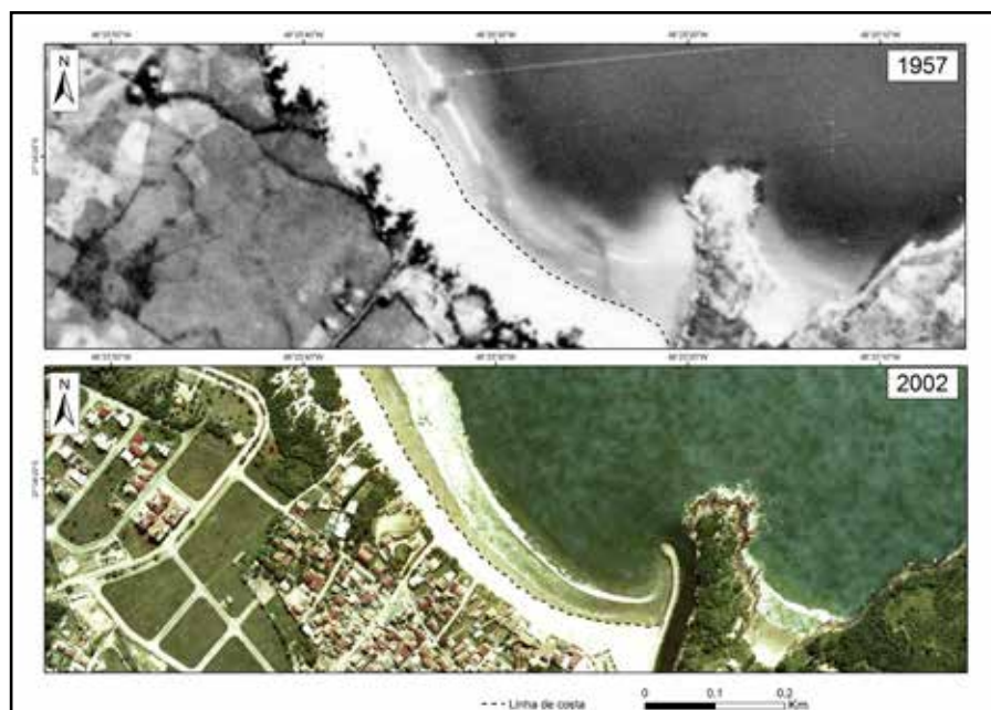
Figura 7: Traçado da linha de costa nas fotografias aéreas e imagens de satélite. Indicador utilizado: areia seca/areia úmida. Fotografias aéreas verticais – 1957-Secretaria de Planejamento e Gestão do Estado – SPG; 2002 - Instituto de Planejamento Urbano de Florianópolis – IPUF.
