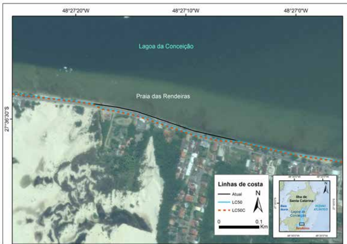
Figura 94: Exemplo de linha de costa futura gerada pela retração adicional ( LC_{50C} ) devido ao efeito da inundação, calculada através do parâmetro I para o cenário de 50 anos na Praia das Rendeiras. LC_{50} é a linha de costa futura calculada através da TEC e Atual é a linha de costa referente ao ano de 2012 coletada em campo. Imagem de fundo: Banco de dados ESRI.
