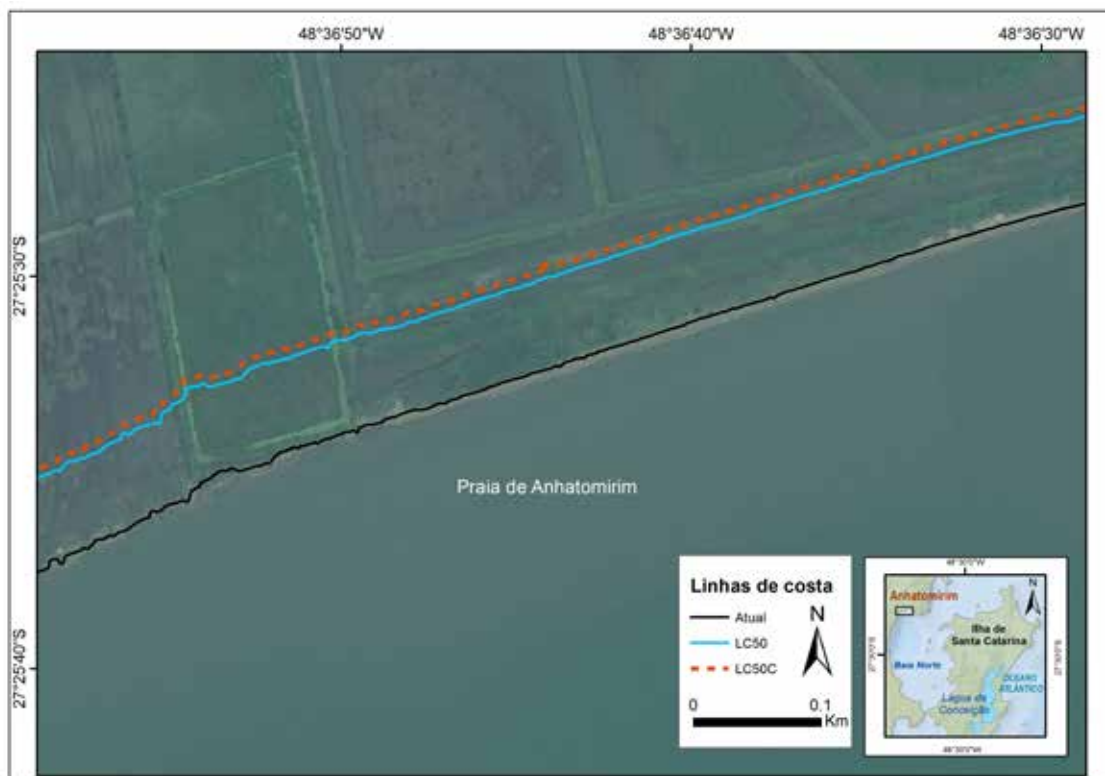
Figura 93: Exemplo de linha de costa futura gerada pela retração adicional ( LC_{50C} ) devido ao efeito da inundação, calculada através do parâmetro I para o cenário de 50 anos na Praia de Anhatomirim. LC_{50} é a linha de costa futura calculada através da TEC e Atual é a linha de costa referente ao ano de 2012 coletada em campo. Imagem de fundo: Banco de dados ESRI.
