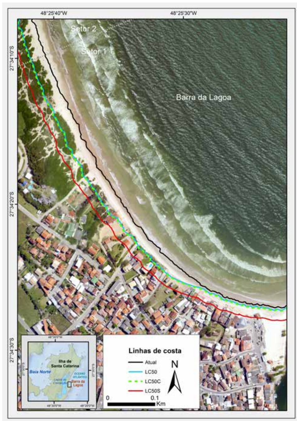
Figura 95: Exemplo de linha de costa futura gerada pela retração por tempestade ( LC_{50S} ) calculada Método da Convolução para o cenário de 50 anos na Praia da Barra da Lagoa. LC_{50C} é linha de costa futura gerada pela retração adicional, LC_{50} é a linha de costa futura calculada através da TEC e Atual é a linha de costa referente ao ano de 2012 coletada em campo. Fotografia de fundo: Secretaria do Desenvolvimento Sustentável de Santa Catarina (SDS, 2010).
