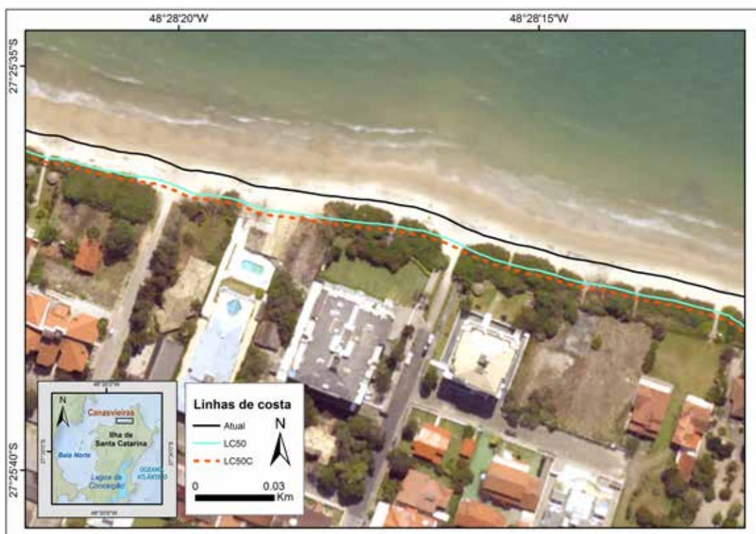
Figura 92: Exemplo de linha de costa futura gerada pela retração adicional ( LC_{50C} ) devido ao efeito da inundação, calculada através do parâmetro I para o cenário de 50 anos na Praia de Canasvieiras. LC_{50} é a linha de costa futura calculada através da TEC e Atual é a linha de costa referente ao ano de 2012 coletada em campo.
