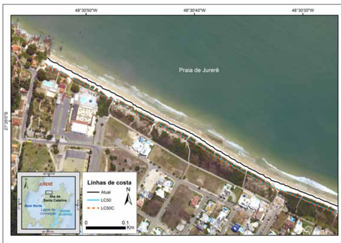
Figura 91: Exemplo de linha de costa futura gerada pela retração adicional ( LC_{50C} ) calculada através da Regra de Brunn para o cenário de 50 anos na Praia de Jurerê. LC_{50} é a linha de costa futura calculada através da TEC e Atual é a linha de costa referente ao ano de 2012 coletada em campo. Fotografia de fundo: Secretaria do Desenvolvimento Sustentável de Santa Catarina (SDS, 2010).
