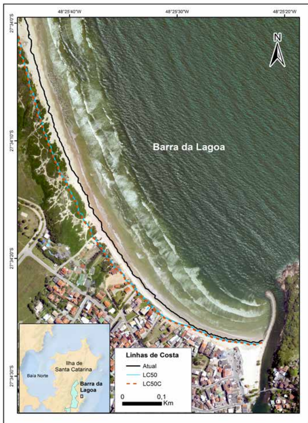
Figura 90: Exemplo de linha de costa futura gerada pela retração adicional ( LC_{50C} ) para o cenário de 50 anos na Praia da Barra da Lagoa. LC_{50} é a linha de costa futura calculada através da TEC e Atual é a linha de costa referente ao ano de 2012 coletada em campo. Fotografia de fundo: Secretaria de Desenvolvimento Sustentável SC (SDS, 2010).
